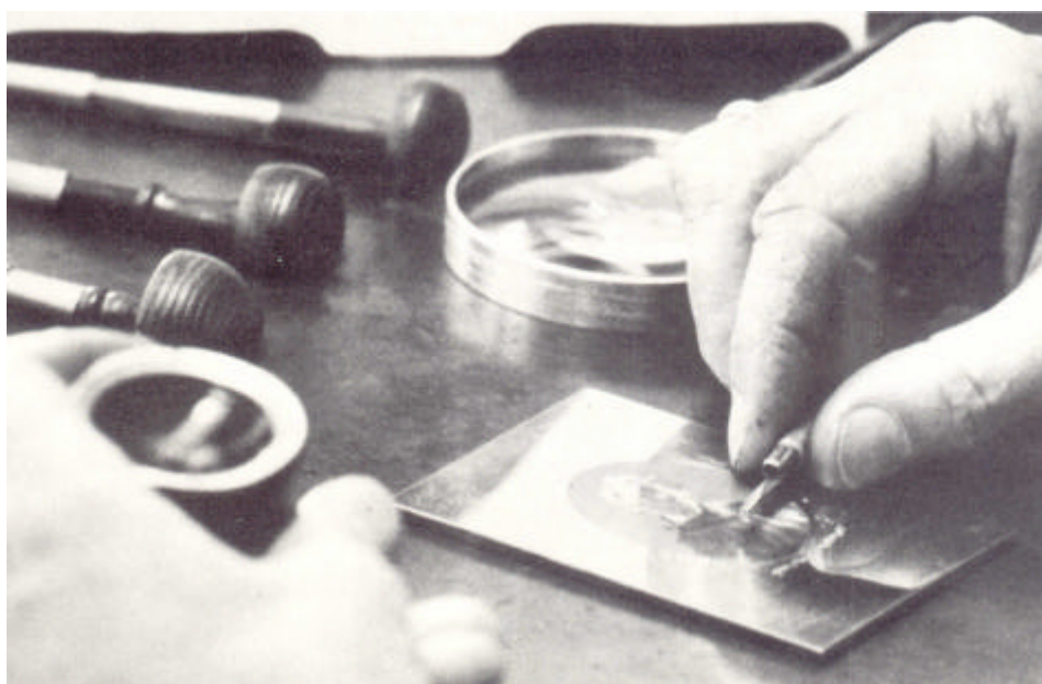
Figura 44 - Detalhes de gravação de uma placa de metal para impressão de papel moeda 55 .
