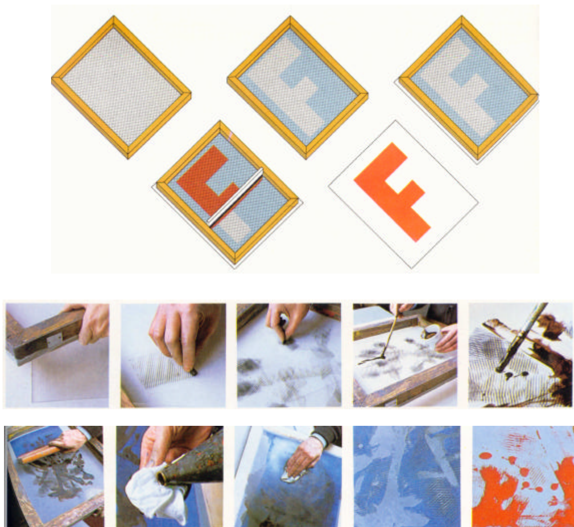
Figura 58 – Etapas de preparo de telas para a impressão em serigrafia 70 .
