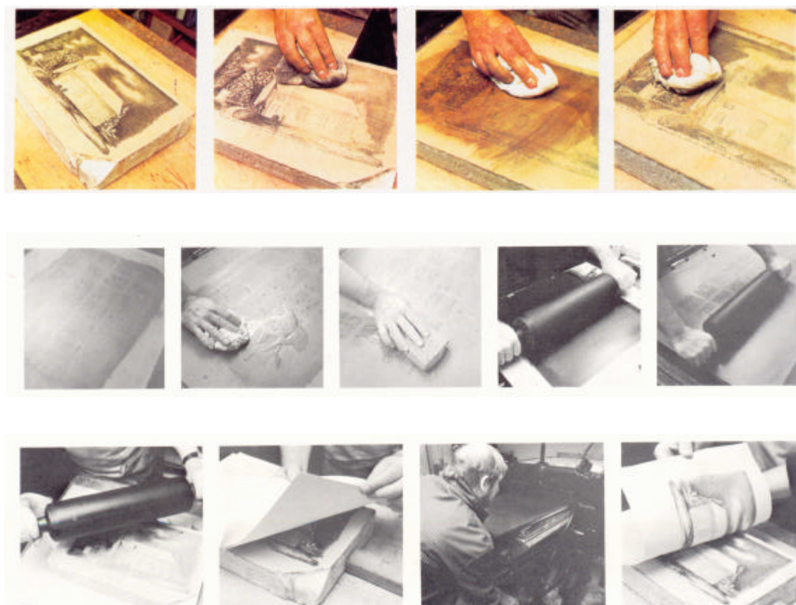
Figura 50 – Limpeza da pedra, entintagem e retirada de uma cópia impressa em litografia 61
